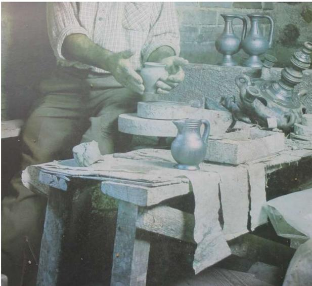
O torno de oleiro tradicional de Molelos consistia numa estrutura em madeira formada por dois pratos ligados por um veio vertical de cerca de 80 cm. O oleiro fazia girar com o pé o prato inferior e de maiores dimensões, também designado de *campo da roda*, que, por sua vez, através do movimento do veio, fazia rodar o prato superior, o *rodalho* ou *cabeça da roda*, onde a peça era trabalhada.
