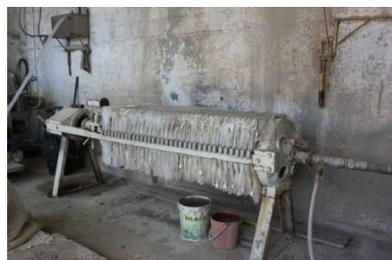
uma nova fornada de barro para ser trabalhado aciona-se uma bomba de sucção que vai buscar o barro ao poço transportando-o sob pressão para dentro de um *filtro/prensa*. Este filtro vai retirar o excesso de água que o barro ainda contém num processo que pode demorar cerca de 3 a 4 horas. O barro retirado
