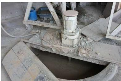
Assim, o chamado barro virgem é inserido num depósito denominado de *turo* onde é diluído e misturado com bastante água. Este processo demora cerca de uma hora. Posteriormente o resultado dessa mistura passa por um *peneiro* onde, como o próprio nome indica, é peneirado, livrando-se assim de todos os resíduos considerados supérfluos (areias e impurezas). Daí o barro passa para um *depósito/reservatório* onde fica armazenado. Sempre que é necessária
